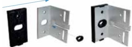
Os Esquadros de retenção, de menor dimensão, suportam os esforços horizontais da carga de vento na fachada. Os parafusos que unem o esquadro ao perfil vertical, devem colocar-se nas perfurações colisas, de forma que permitam um leve movimento do perfil em sentido longitudinal.
